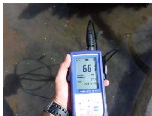
写真 3.45 現地の濁度測定結果(攪拌)
