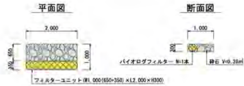
法覆工及びろ過設備詳細図
