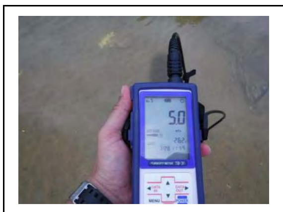
写真 3.44 現地の濁度測定結果
