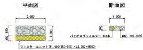
法覆工及びろ過設備詳細図
