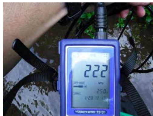
写真 3.47 現地の濁度測定結果(攪拌)
