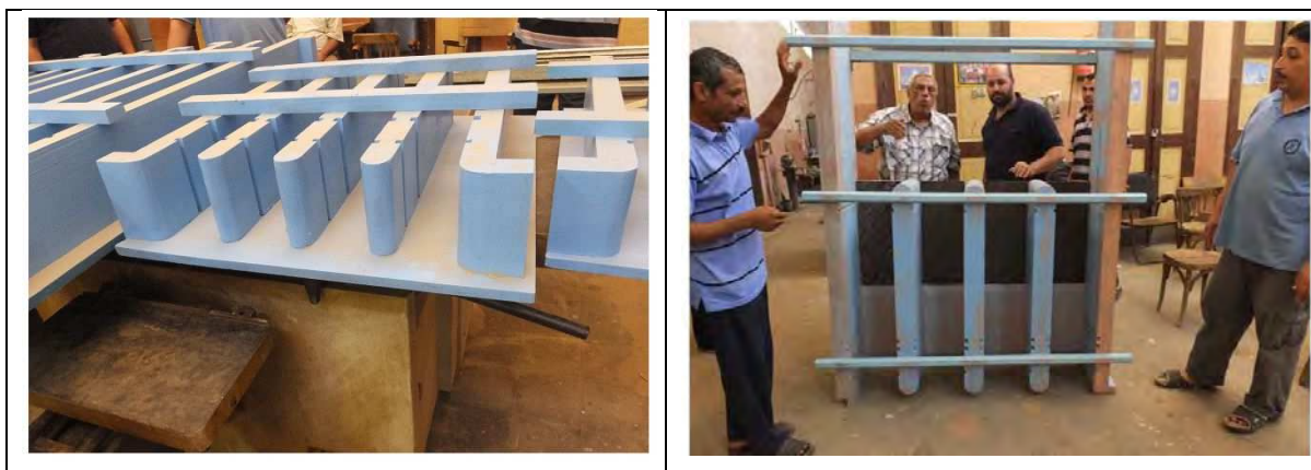
図 3-2.16 新堰の製作現場（大規模新堰の製作）
