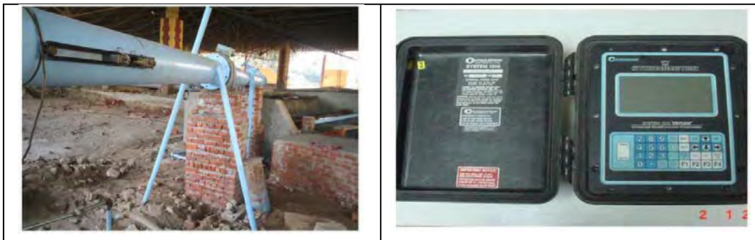
図 3-2.2 流入量の計測装置（電磁流速計）
