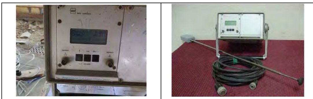
図 3-2.5 流速の計測装置 (マイクロカレントメーター)
