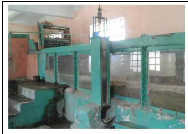
3-3.4 水位の計測装置（ポイントゲージ）
