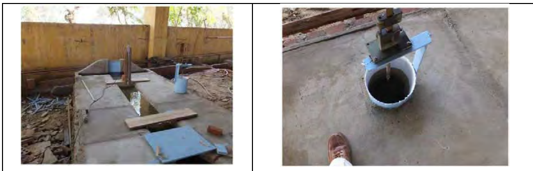
図 3-2.4 水位の計測装置 (ポイントゲージ)
