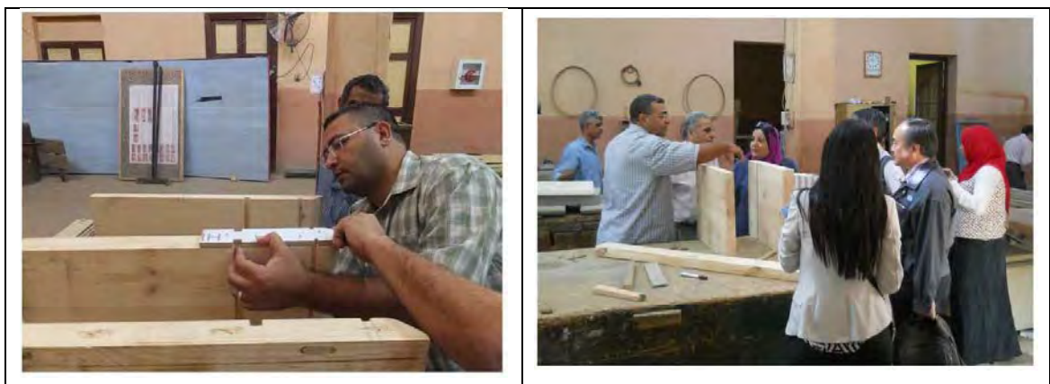
図 3-2.6 既存堰の製作現場 (小規模堰のピアの製作)
