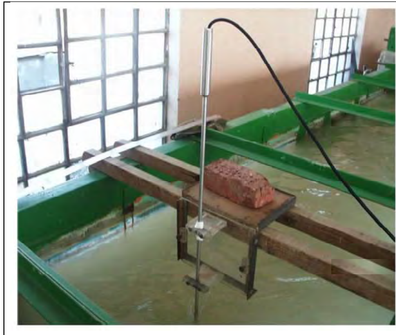
図 3-3.5 流速の計測装置（マイクロカレントメーター）
