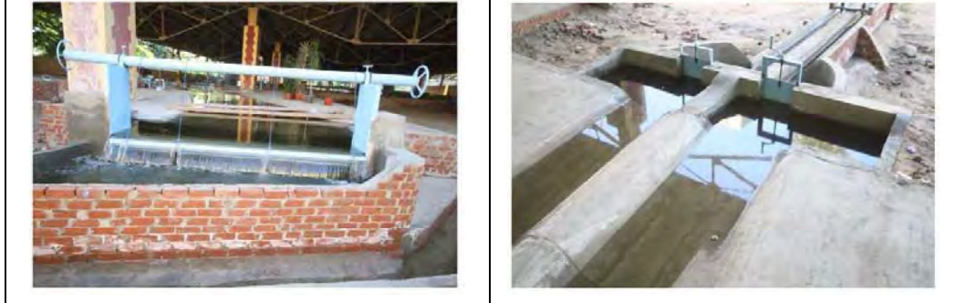
図 3-2.3 流出量の計測装置 (堰)
