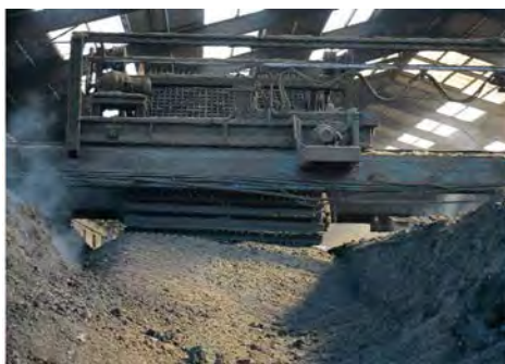
スクープ式切返し装置（処理能力：4,200t/月）
