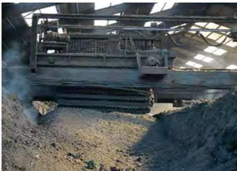
スクープ式切返し装置（処理能力：4,200t/月）
