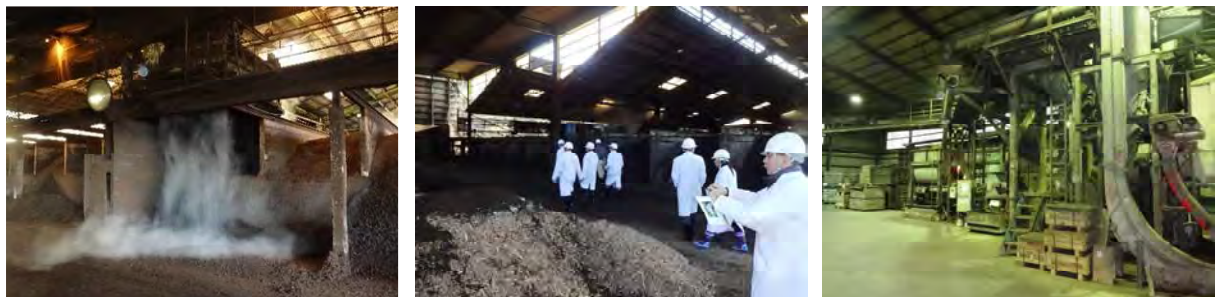
・発酵槽から排出される堆肥 ・炭化された湿潤汚泥 ・炭化装置
