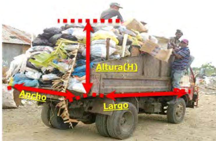
**Figura 10 Método analítico para determinar las medidas de equipos**
