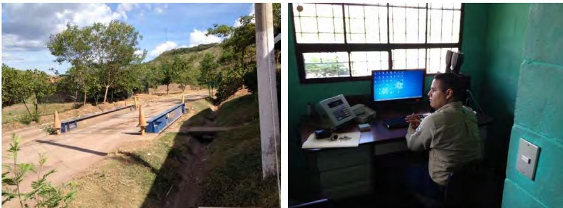
**Foto 20 Balanza con registro computarizado de peso en el relleno sanitario de ASINORLU - El Salvador.**
