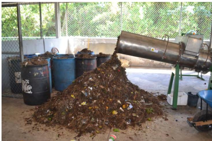
**Foto 3 Máquina trituradora de residuos en la planta de compostaje de Punta Cana, R.D.**
