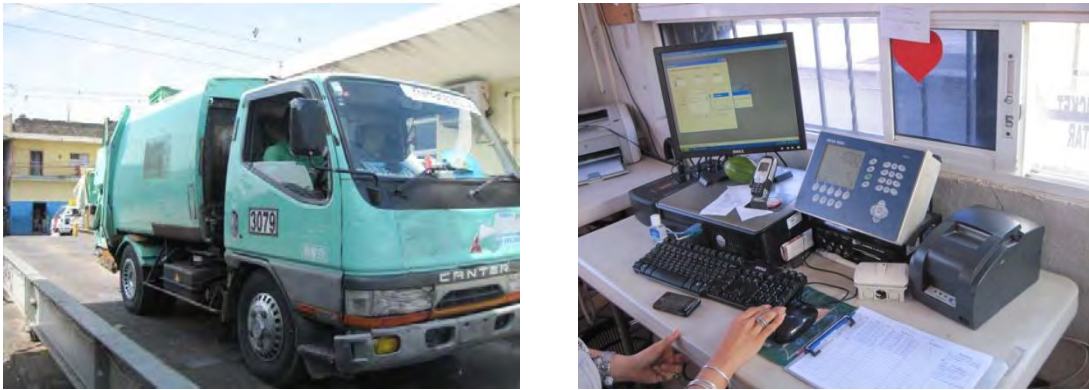
Foto 13 Balanza y sistema computarizado para registro del peso de camiones
