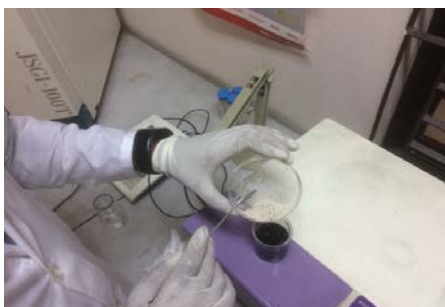
研究風景 サンプル水にモリンガ粉末を添加する。
