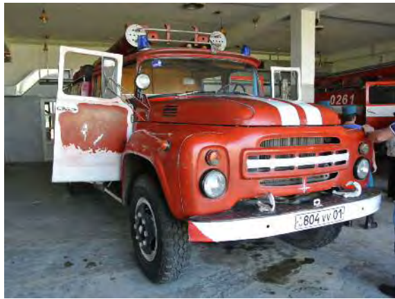
RSに配備されている消防車2,000Lit水槽付き消防ポンプ車（旧ソ連製で1980年代の車両） 撮影場所：ロリ地方（Vanadzor）
