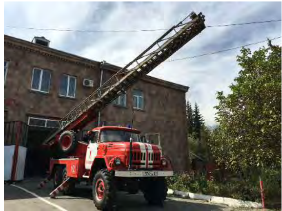
旧ソ連製のはしご車はバスケットを装備していない上、安全装置等の故障により、使用できない状態である 撮影場所：ロリ地方（Vanadzor）
