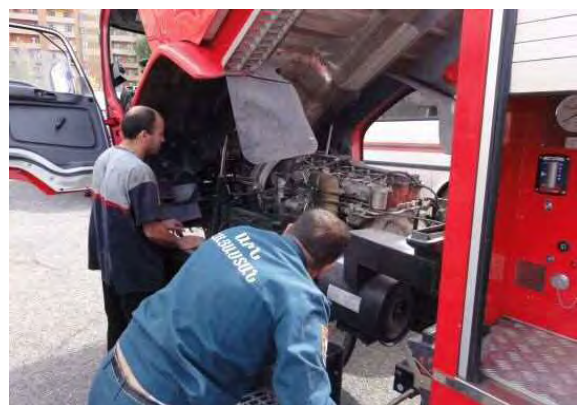
整備中の3,500Lit水槽付き消防ポンプ車（エレバン市消防機材整備計画で調達） 撮影場所：エレバン市
