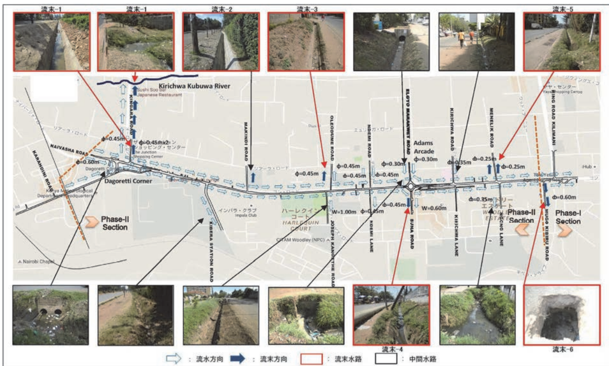
図 3-2-7 道路排水系統図（現況流末水路）
