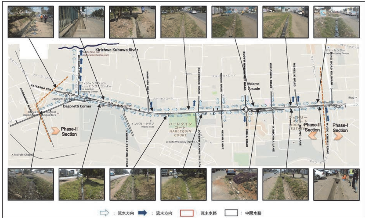
図 3-2-6 道路排水系統図（現況中間水路）
