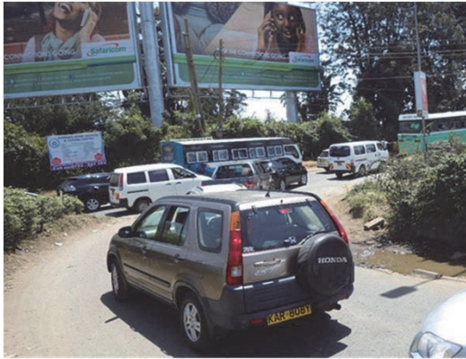
ダゴレッティコーナー交差点 交差点形状が悪く、本道(ウゴンゴ道路)に流入する車両により、支道も含めて交通渋滞が発生している。
