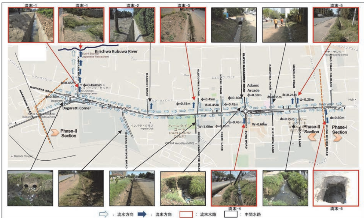
図 3-2-7 道路排水系統図（現況流末水路）
