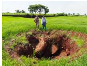
写真-6 ディアスポラ付近で 2013 年に実施した PA3-2 試験井跡。表層部は火山泥流状堆積物が分布。
