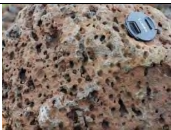
写真-1 Qv2 溶岩には気孔が多く、透水性が高く、良好な帯水層を形成するものと期待される
