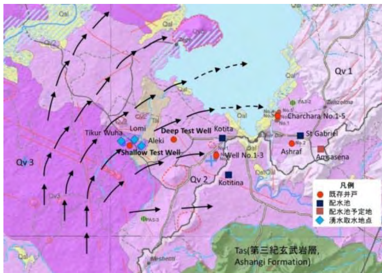
図-1. バハルダール市、周辺部地質図。第四紀玄武岩溶岩層 (Qv1, Qv2, Qv3) の概略の流動方向を矢印で示す。第四紀溶岩層中に想定される帯水層の地下水も、タナ湖の湖底の下をほぼ矢印方向に流動しているものと想定される。既存井戸(生産井、観測井)位置を赤丸で示す。出典 ; Detailed Groundwater Study, 2013 (MoWIE) に加筆。
