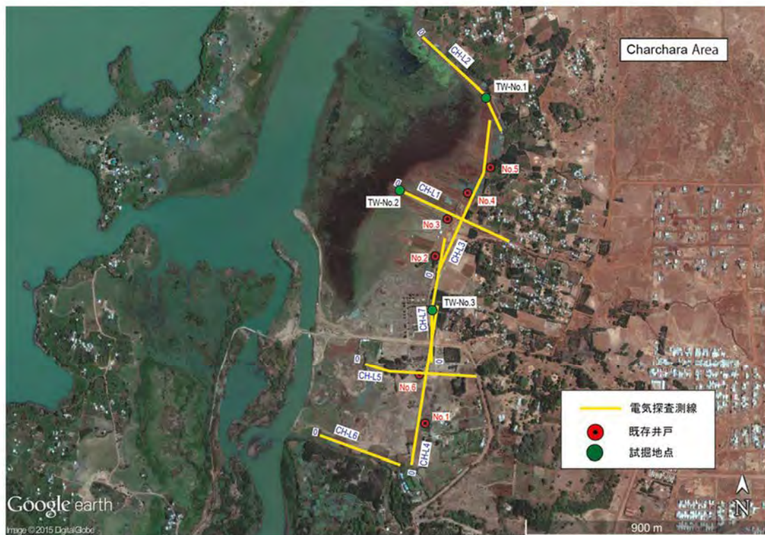
図 3-2 Charchara 地区の電気探査実施測線位置および試掘位置図
