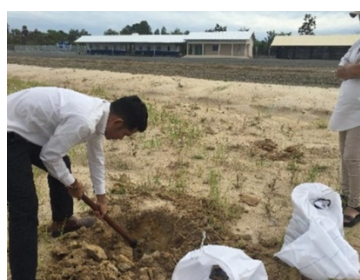
施工現場での土採取 1
