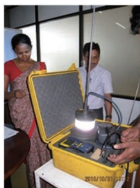
キャンディ市所有の相関式漏水探知機
