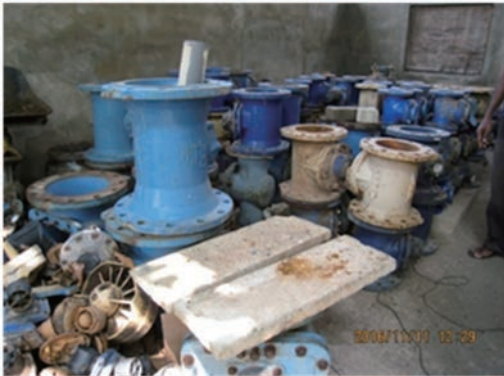
羽根車式バルクメーターと羽根車 (Meter Workshop and Testing Lab)
