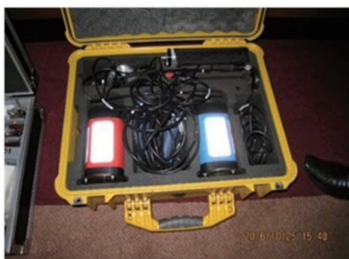
相関式漏水探知機 (西部州中部 RSC : 2台あるうちの1台は使用不能)
