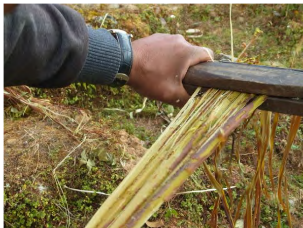
外皮（黒皮）をCheppuwaという道具で大きく剥いている様子
