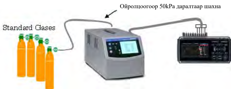
Зураг 6-1 Японд үйлдвэрлэсэн газ анализаторт стандарт хий шахах
