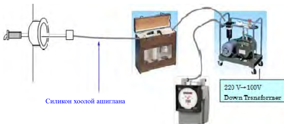
Зураг 8-11 Тоосны дээж авагч багажны холболт
