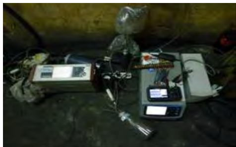
Зураг 8-16 Хийн найрлага хэмжигч газ анализаторын холболт (Дулаан өрөөнд)
