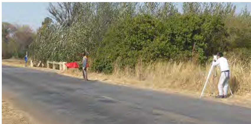
写真 2-6 GPS 水準測量 既存水準点から GPS 観測点（参照点）への標高の取付水準観測
