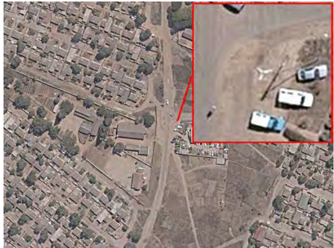
写真 2-5 対空標識の地上写真（左）と航空写真での見え方（右）
