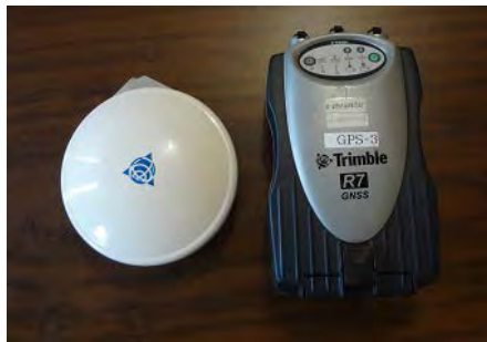
写真 2-3 GPS 受信機 :Trimble 製
