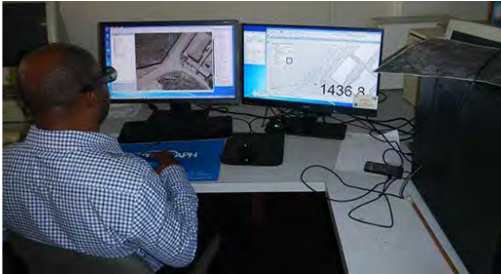
(出典：JICA 調査団) 写真 3-5 デジタル図化機とデジタル図化の作業風景
