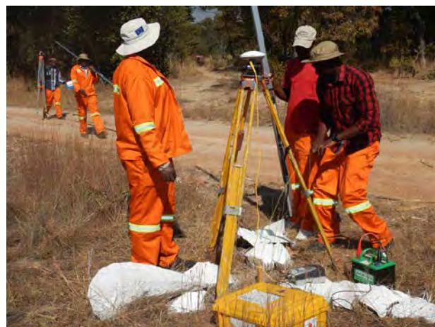
GNSS 観測の作業風景
