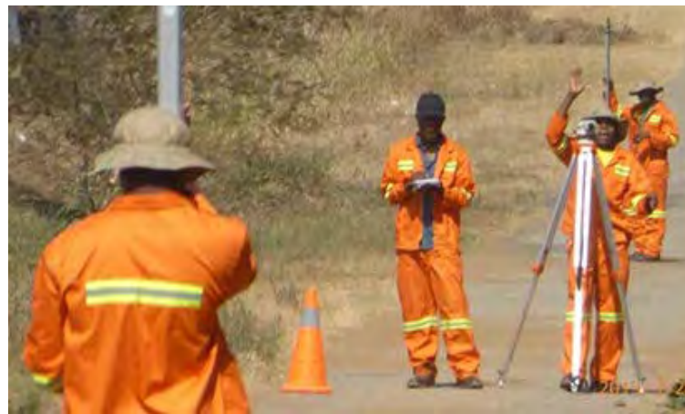
写真 2-7 DSG 職員による水準測量の様子
