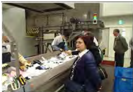
Qendra e Riciklimit Ogaki. Këtu, të riciklueshmet e grumbulluara nga familjet ndahen sipas materialeve manualisht. Pastaj, të riciklueshmet pakëtohen nga një kompresor.
