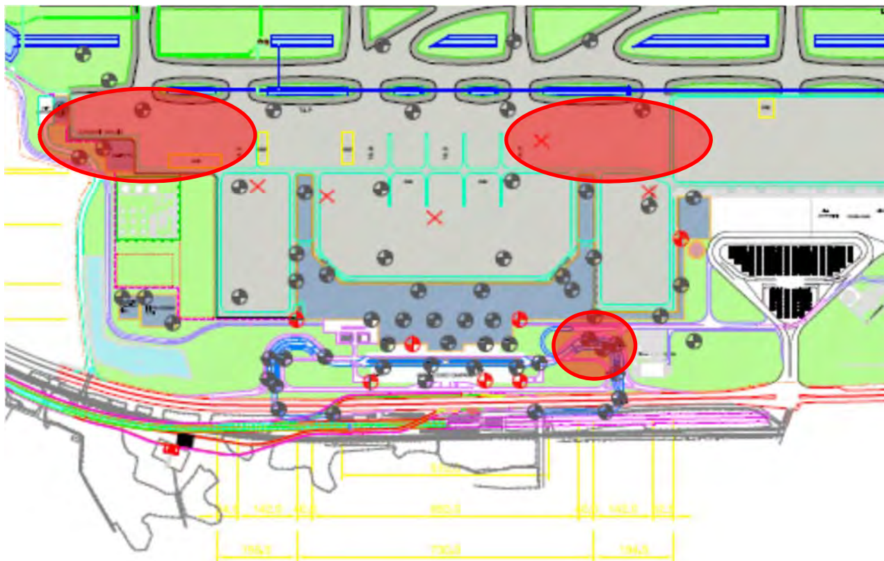
図 8-2 地盤改良エリア（新エプロン、構内アクセス道路の一部）
