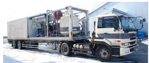
図 3.18 車両搭載式スラリーアイス製造装置のイメージ (他社製品)
