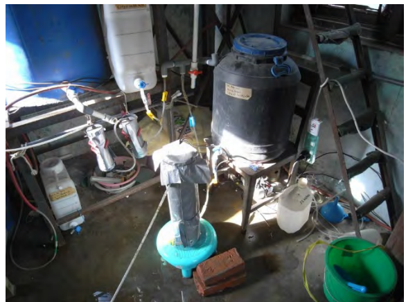
アナモックス装置（嫌気性アンモニア酸化） (撮影場所：Jwagal/撮影日：2016年11月21日)
