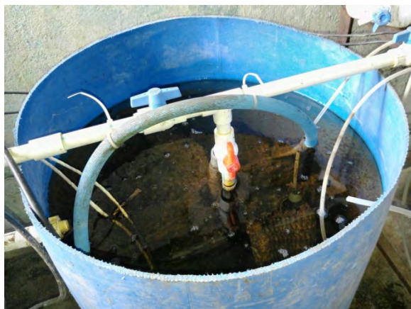
ドロッピング硝化装置（アンモニア態窒素除去） (撮影場所：Jwagal/撮影日：2016年11月21日)
