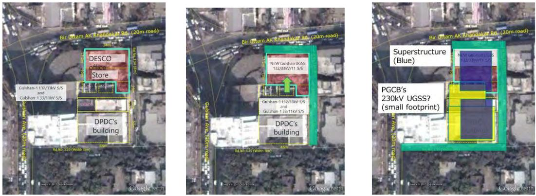
(Step1. 132kV UGSS 建設) (Step2. 撤去) (Step3. 230kV UGSS と上部建物建設)
