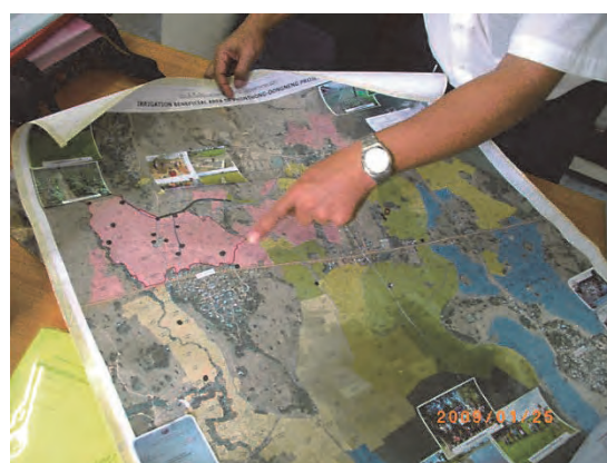
写真 6：先行プロジェクト（PIAD）で作成した対象サイト地図。こうした加工地図は、各農家の所有する区画・面積の把握、灌漑整備計画、水利費徴収等に利用されていた。
