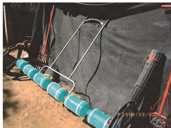
写真12：PIADが支援した播種用ハンドローラーと手押し除草機（サイブリ郡ソムサード地区）
