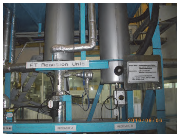
FT 反応装置（高温高圧で爆発の危険があるため 取り扱いには留意が必要）
