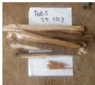
② 燃焼試験に用いた着火材(木片)10gと薪750g
