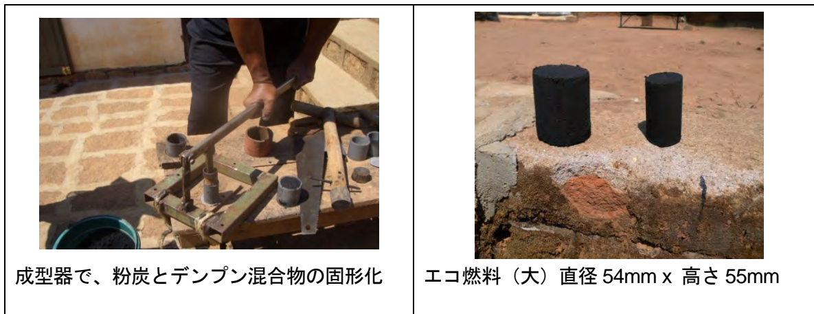
写真 2 エコ燃料の製造方法/2016 年 JICA 調査団撮影
