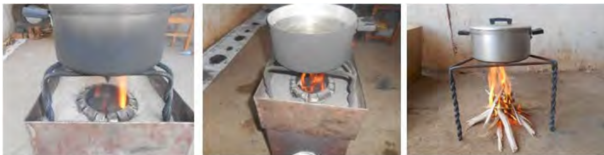
Hybrid RCS: 薪とエコ燃料の混焼試験 (薪の炎がロケットの様に噴出)
