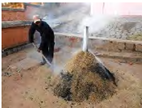
クンタン器を用いたモミガラの炭化作業
