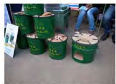
⑥粘土製バケツ型カイゼンカマド
