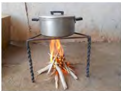
① 3点カマド(3つ足五徳)を用いた薪の燃焼試験/JICA調査員宅にて
