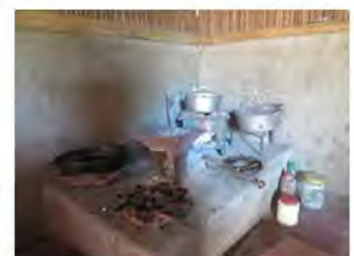
⑥ ブリキ製カイゼンカマド、3つ足や4つ足の五徳/農家C
