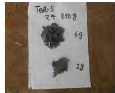
③ 燃焼終了後の重量測定(未燃焼物6gと灰2g)
