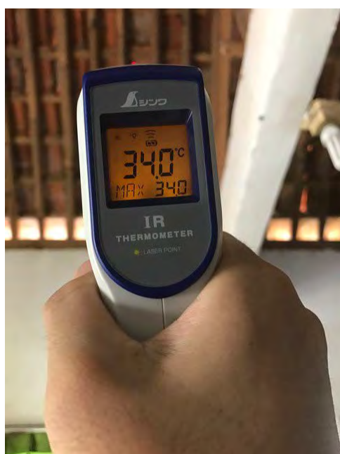
屋根裏面温度（未塗布）
