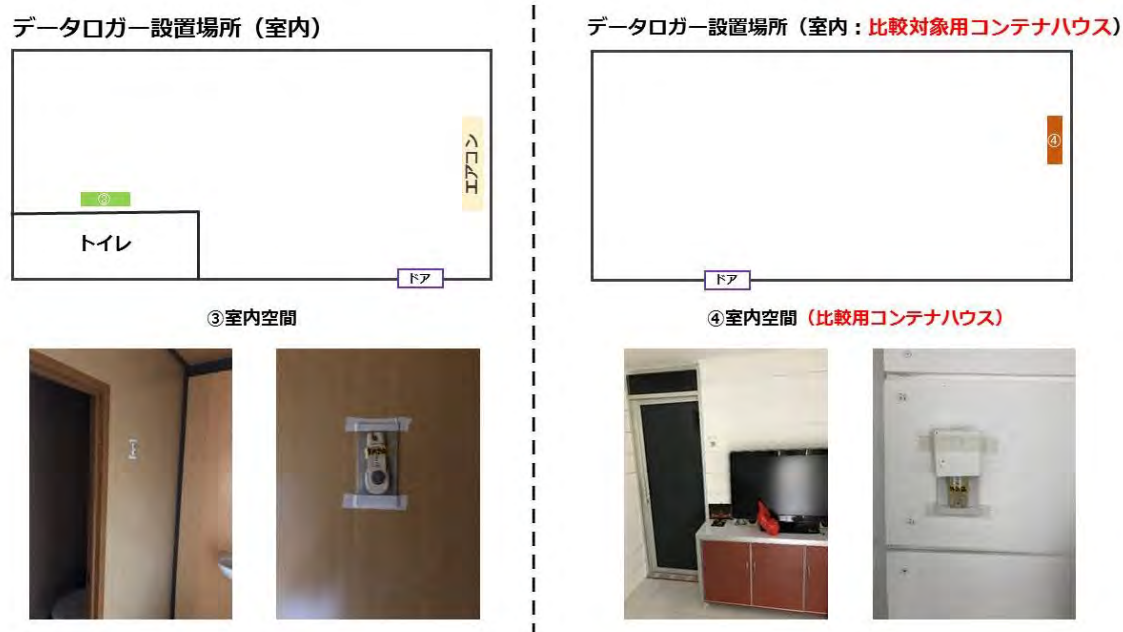
図 7-4 データロガー設置場所（室内） 地上から 160cm ほどの位置に、データロガーを設置。
