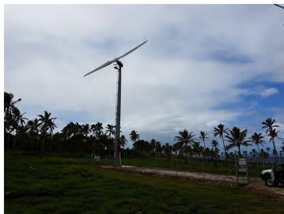
可倒式風車 (11kW)
