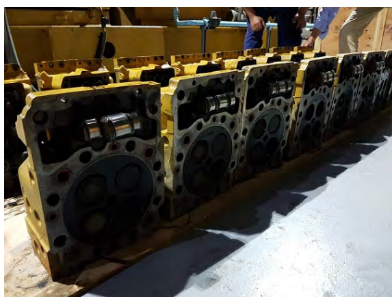
取り外されたシリンダーヘッド 日本では取り外した部品を調整し再度使用することが多いが、TPL ではオーバーホールごとに新しい部品に交換している。
