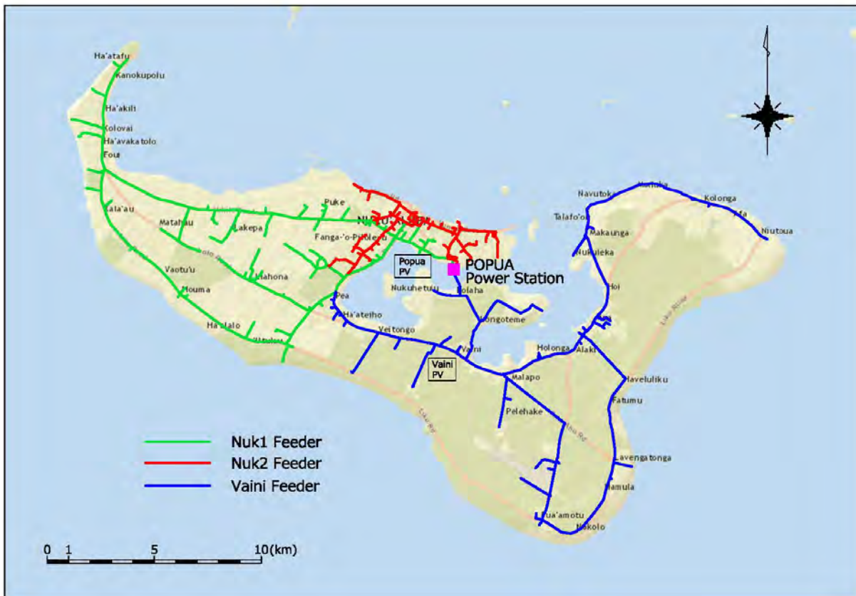
トンガタブ島 送配電線系統図 (現況)
