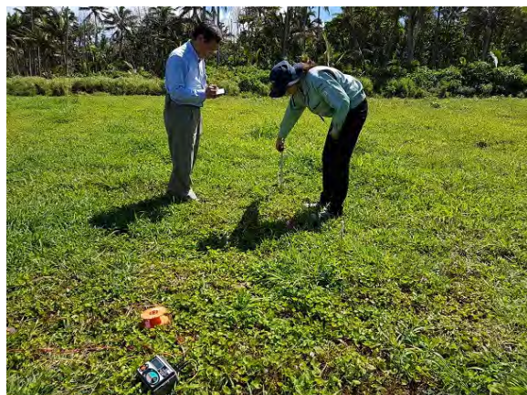
接地調査 ニウトウア地区の風況観測地点で実施した。抵抗値は非常に小さく、大掛かりな接地工事は必要ないことが確認された。
