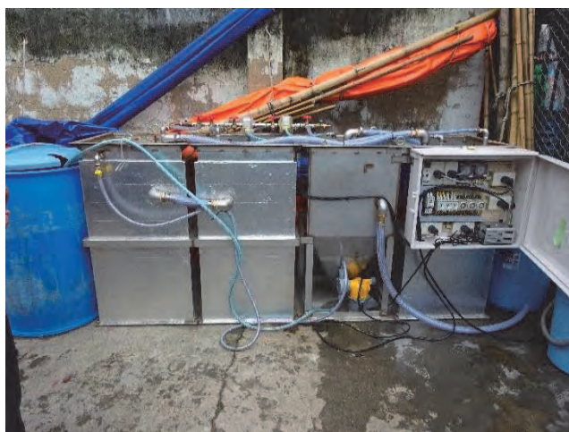
ナム・ハイ魚市場に設置した排水処理試験装置
