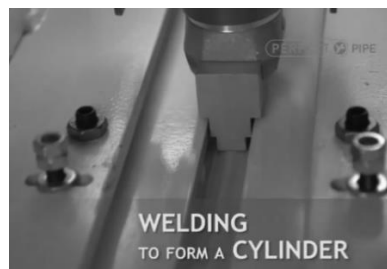
出典：BilCon 社（シンガポール） 内面ライニング樹脂層溶着工程
