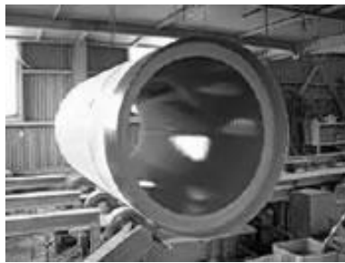
図 20 ライニング管製造方法（機械的結合方式）
