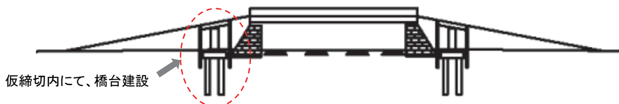
図 11.3.3 タイプ 1 橋梁ステップ 1 概念図
