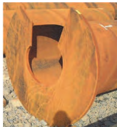
図 6.2.5 回転鋼管杭の写真（左：打設機械、右：回転鋼管杭の杭先）
