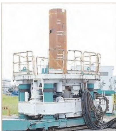
図 6.2.5 回転鋼管杭の写真（左：打設機械、右：回転鋼管杭の杭先）
