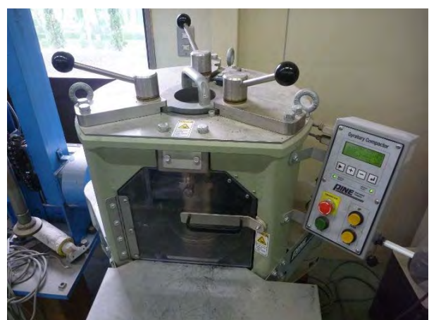
写真 SGC 試験機による締固め試験状況
