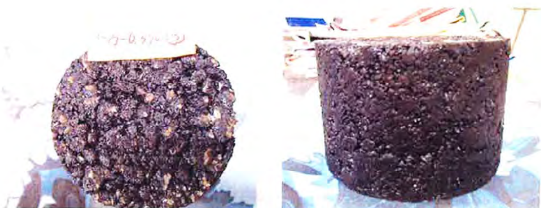
写真 下方粒度アスファルト量 4.5%(OAC - 0.3%)の供試体の締め固めた後の外観
