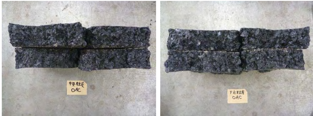
写真 水浸WT試験後の断面（左：中央粒度 OAC、右：下方粒度 OAC）
