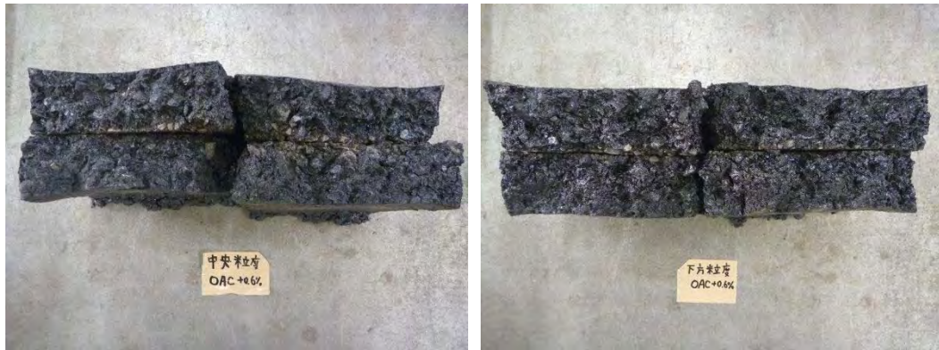
写真 水浸WT試験後の断面（左：中央粒度 OAC+0.6%、右：下方粒度 OAC+0.6%）
