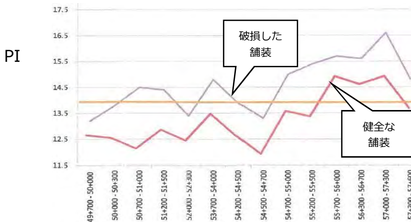
図 6.1 破損した舗装と健全な舗装のPIの比較
