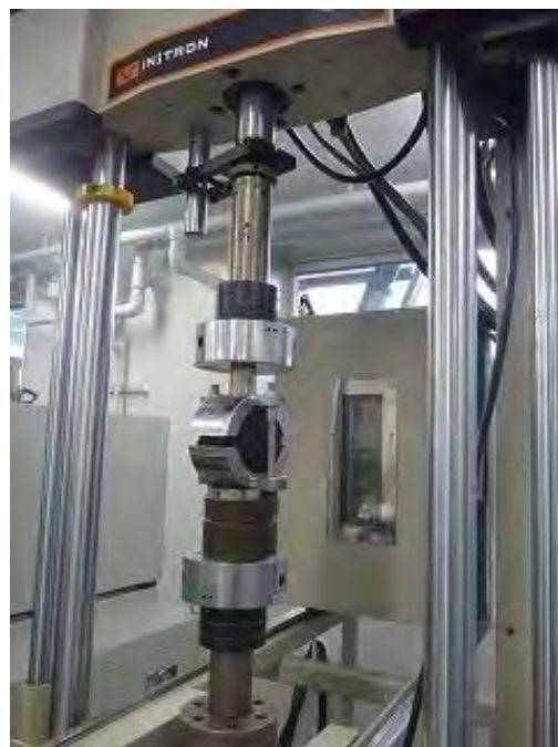
写真 マーシャル安定度試験状況
