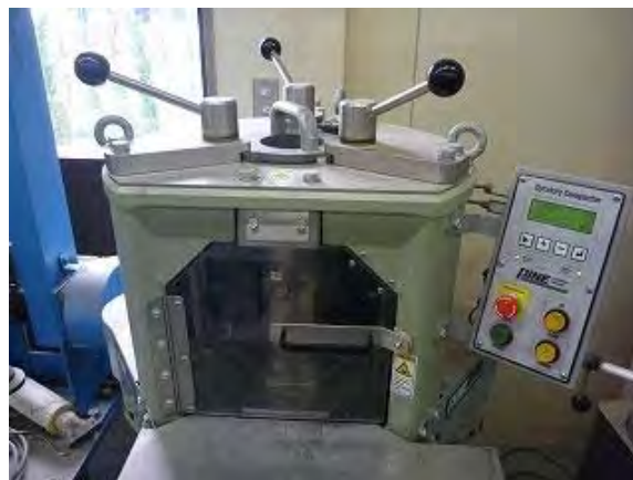
写真 SGC 締固め試験状況
