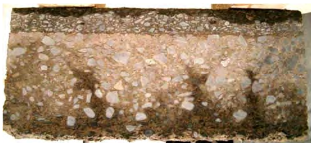
写真 セメント安定処理路盤の疲労ひび割れ 出典：NCHR, USA
