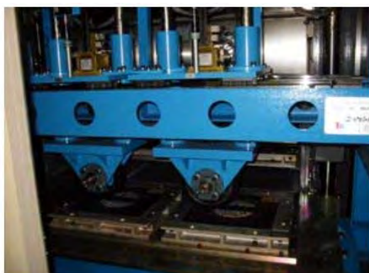
写真 ホイールトラッキング試験(日本)
