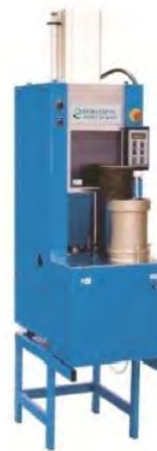
写真 SGC(Super Pave Gyratory Compactor)
