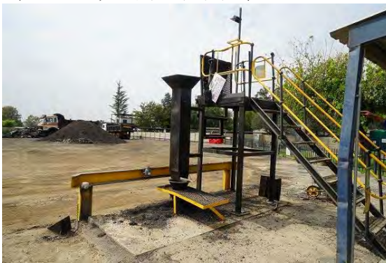
南ア：Much Asphalt ダンプトラック荷台からサンプル採取
