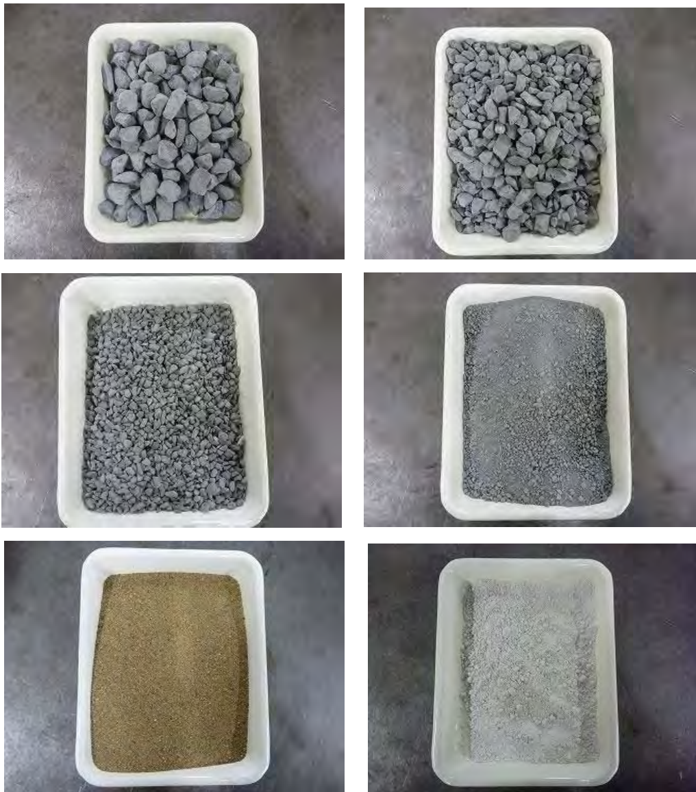
写真 4.3.1 使用骨材の外観（上段左：5号、上段右：6号、中段左：7号碎石、中段右：碎砂、下段左：細目砂、下段右：石粉）
