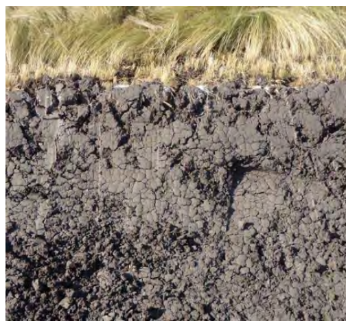
写真 乾燥状態の膨張土（CBR 調査等では高強度を示す場合がある）
