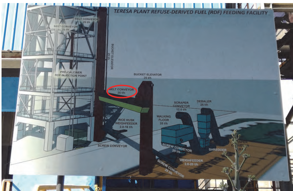
リパブリックセメント工場内に導入されている RDF 燃料投入装置 (時間当たり 25t 利用することが可能な設計と示されている)
