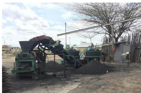
写真 4-2 Mkaa Bora の練炭製造装置
