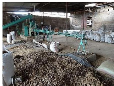
写真 4-1 Nandra Engineering（モシ）が導入したピストン式木くず固形燃料製造装置
