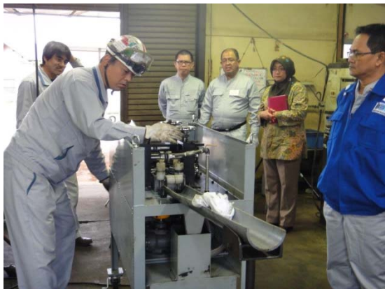
写真10 本邦受入活動での熱交換チューブ半割
