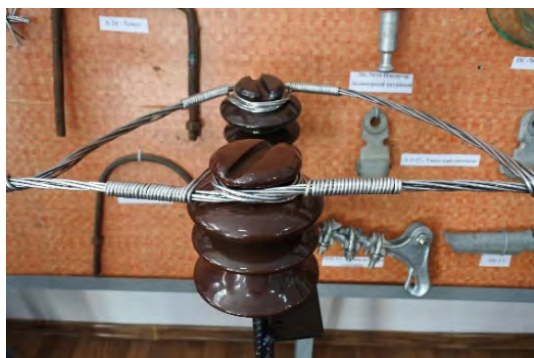
別添図 7-1 配電線の碍子への添架状況 (BT 研修室にて)
