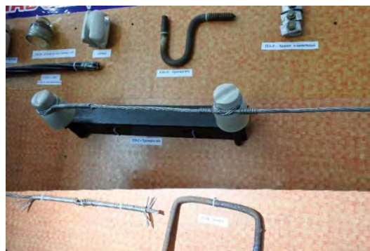
別添図 7-1 配電線の碍子への添架状況 (BT 研修室にて)
