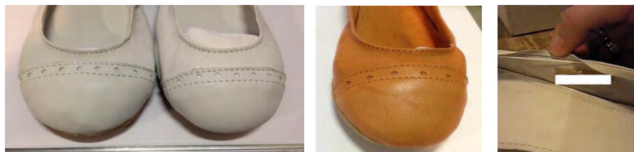
左) 左右つま先部分の縫い位置のずれ 中) つま先部分の革にシミ 右) 縫製の不具合による芯材の露出
