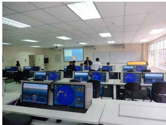
写真 6-2 Desk top 操船シミュレーター。PC 上で訓練を受ける
