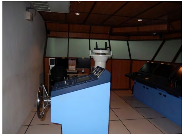
写真 8-4 操船シミュレーター第2 船橋を調査。LCD 方式のシミュレーターである
