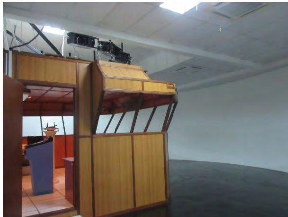
写真 8-3 操船シミュレーター主船橋を外からみる。プロジェクターが見える
