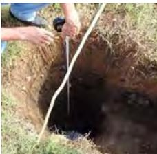
試掘②では、陸上地形調査結果から試掘地点の地盤は C.D.L.+3.55 であり、隣接する小河川の水位と同程度であると推定し、地下水位を C.D.L.+1.20 とすれば、試掘地点の地下水位は地表面下約 2.35m (=3.55-1.20) となり、浸透排水量は 1 時間当たり 295 mm 程度である。
