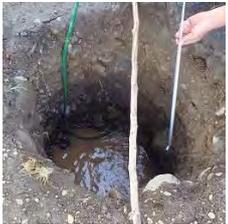
試掘 TP-1 では、陸上地形調査結果から試掘地点の地盤は C.D.L.+5.20 であり、隣接する小河川の水位と同程度であると推定され、地下水位は C.D.L.+1.60 程度と見込まれる。この場合、TP-1 地点の地下水位は地表面下 3.6m (=5.20-1.60) 程度の深さとなり、浸透排水量は 1 時間当たり 195mm 程度である。
