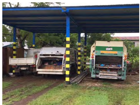
アロタウ市 LLG 所有のゴミ収集車 (左から2tダンプ、6 m 3 容量、8 m 3 容量)
