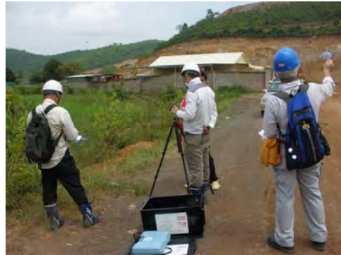
砕石場周辺における発破による振動測定
