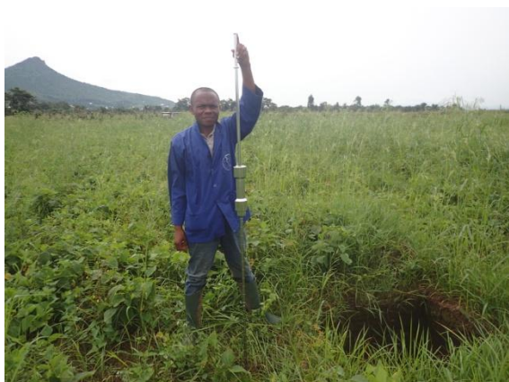
Essai de pénétration dynamique simple
