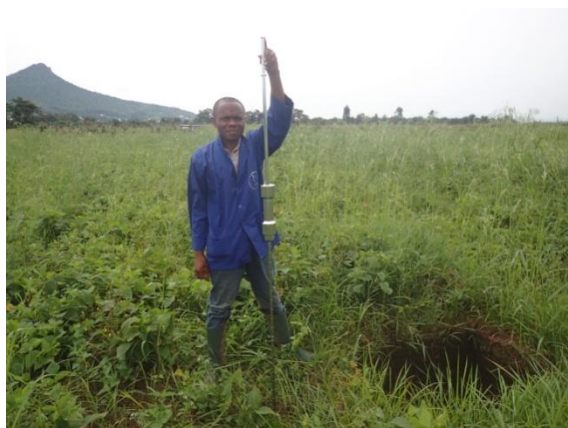
簡易動的コーン貫入試験の様子
