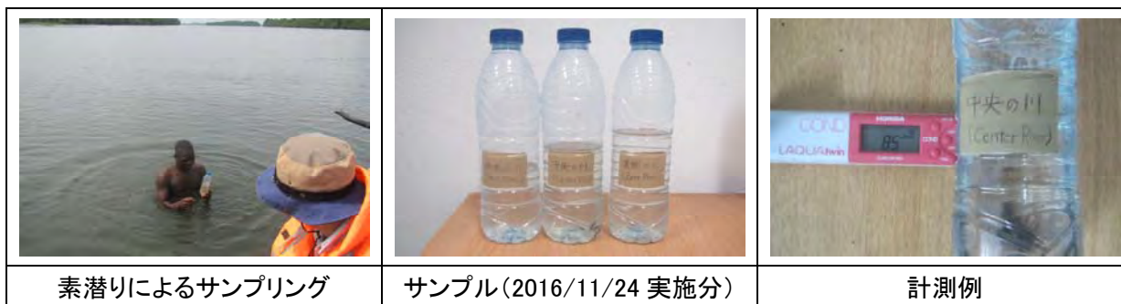
写真 2.1 ジェバレ島周辺の塩分濃度の計測状況
