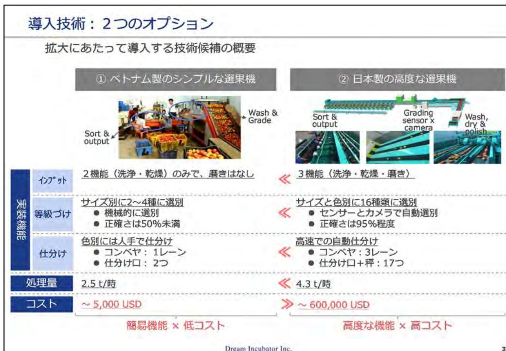
図 32 拡大にあたって導入する技術候補の概要
